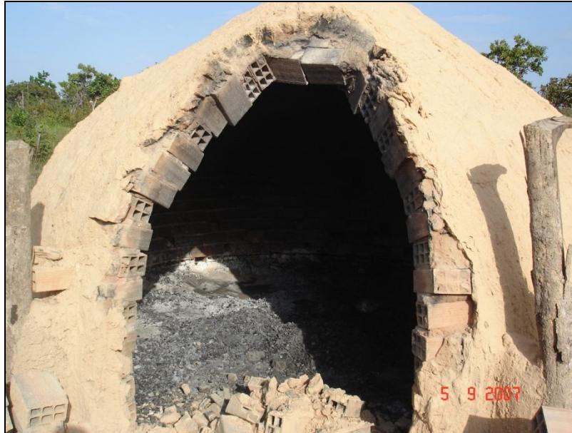
Figura 6: Forno artesanal para fabricação de carvão. Fonte: SEMA (2007).
